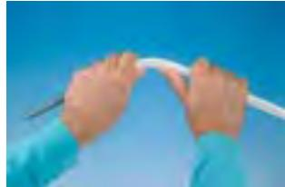
Изгиб при помощи внешней спиральной пружины
