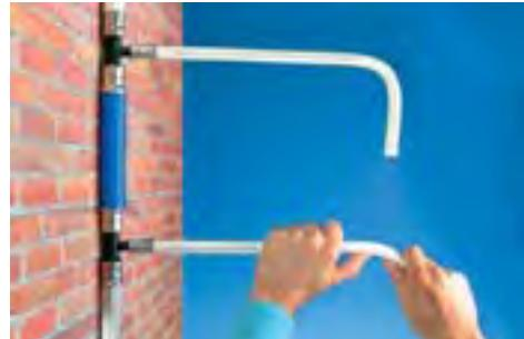
При наличии в системе пресс и резьбовых (обжимных) соединений, в первую очередь следует установить резьбовые, а затем пресс соединения.
