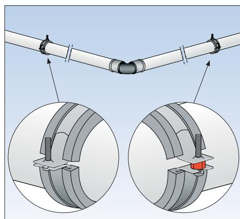
Правильно выбранное положение подвижных и неподвижных опор – очень важное условие при использовании компенсаторов и углов. При всех изменениях направления, должны быть установлены компенсаторы расширения.
