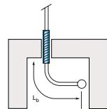
Если короб слишком мал для установки рассчитанного компенсатора, то следует увеличить отверстие в стене для обеспечения достаточного места для движения. Через отверстие в стене следует пропускать трубу в PE -изоляции.
