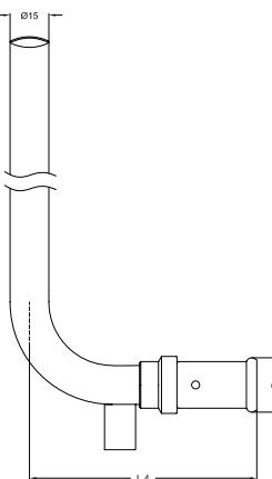
**ТИП: 39Р** Нижнее подключение к радиаторам, закрытое, никелированная медная труба, Ø 15, 300мм
