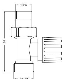
**ТИП: RADP** Медная никелированная трубка Ø 15мм
