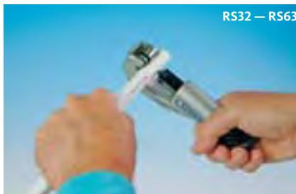
Производите калибровку трубы калибратором Kalispeed. Вставьте калибровочное устройство правильно в трубу поверните таким образом, чтобы образовалась равномерная фаска с внутреннего и внешнего края трубы. Удалите все отходы.
