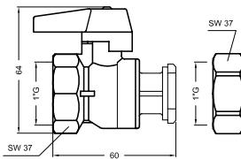
**ТИП: V-4070** Пара шаровых кранов 1" с накидной гайкой и прокладкой (красный + синий) и термометром 0-50°C
