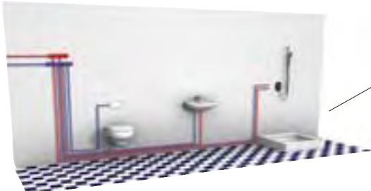
Подача холодной и горячей воды к каждому изделию сантехнического оборудования производится по разным трубам
