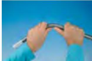
Изгиб при помощи внутренней спиральной пружины
