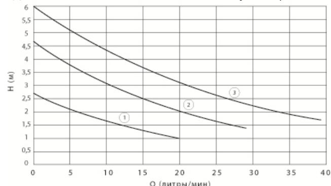
**Рис. 3. Рабочее поле для насосов ELS 25-8, ELS 32-8 (230 В ~ 50 Гц)**
