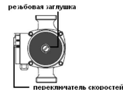
Если система заполнена водой, удаление воздуха из насоса происходит автоматически в течении короткого времени после включения насоса.
