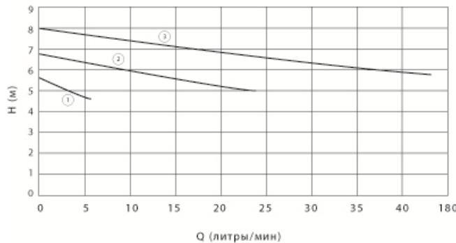
**Рис. 2. Рабочее поле для насосов ELS 25-6, ELS 32-6 (230 В ~ 50 Гц)**
