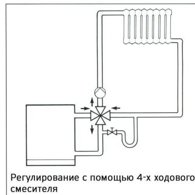
Регулирование с помощью 4-х ходового смесителя
