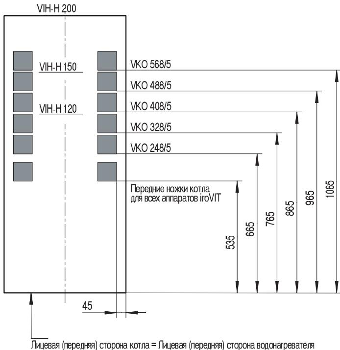
В случае установки котла iroVIT VKO или atmoVIT VK сверху на водонагреватель рекомендуется использовать в качестве подложки специальные коврики. Это позволит устойчиво расположить котёл, избавив его тем самым от возможного скользывания, а также предохранит поверхность корпуса водонагревателя от царапин. Расположение ковриков в зависимости от типа, марки котла и его геометрии выбирается согласно представленному на чертеже.
