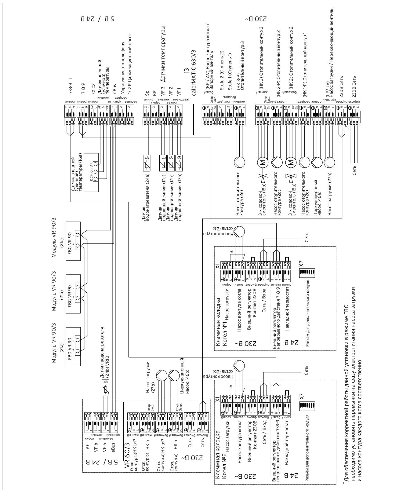
\* Для обеспечения корректной работы данной установки в режиме ГВС необходимо установить перемычки на фазы электропитания насоса загрузки и насоса контура каждого котла соответственно
