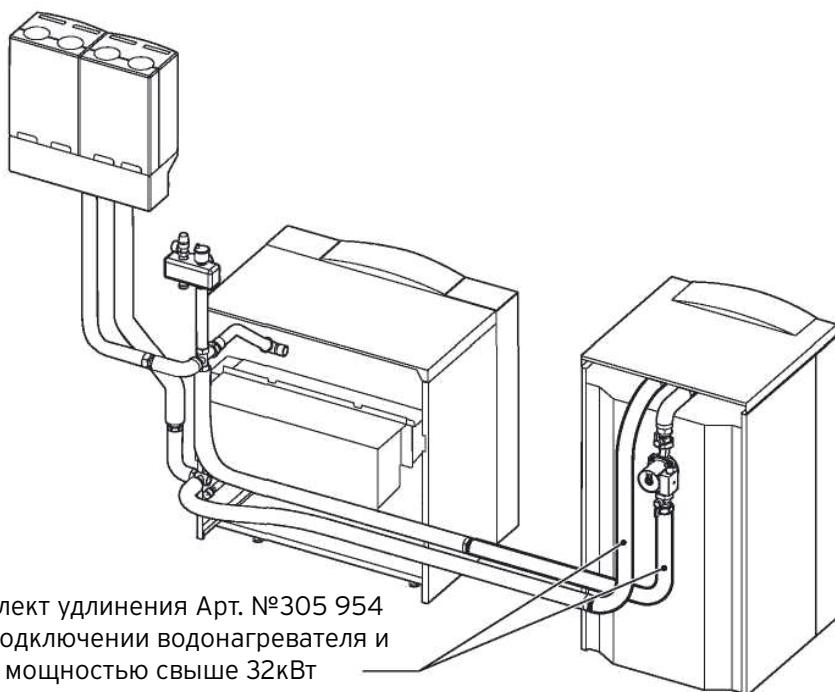
Пример установки котла мощностью более 32 кВт и водонагревателя слева (вид на оборудование спереди) рядом с котлом, с присоединительным комплектом водонагревателя и удлинением присоединительного комплекта водонагревателя № 305954.
