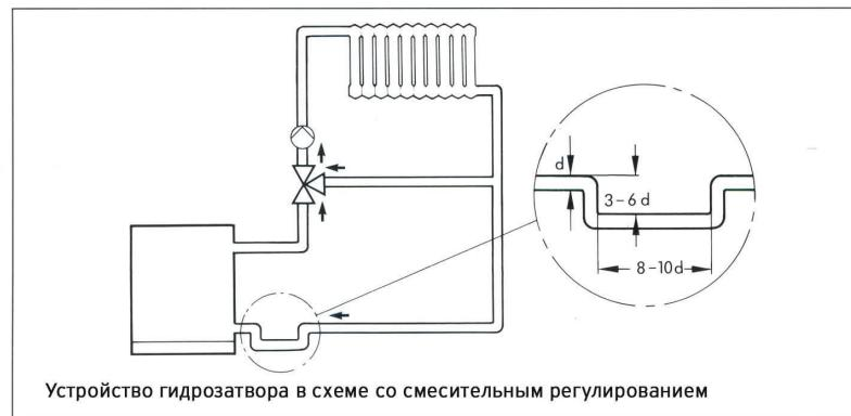
Устройство гидрозатвора в схеме со смесительным регулированием
