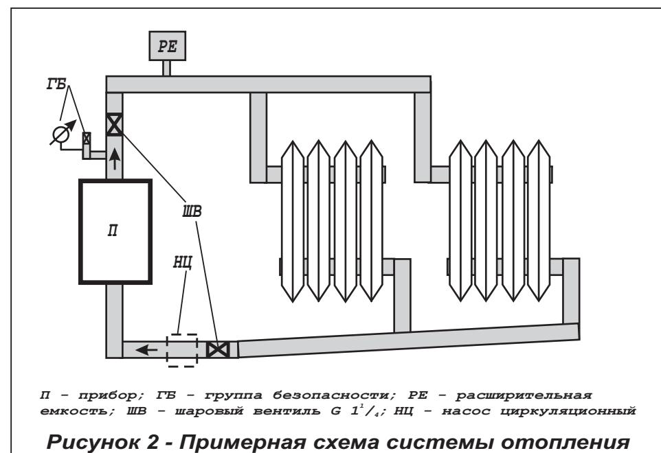
6.1.8. Прибор должен быть смонтирован в вертикальном положении (выходной патрубок - вверху) на стенах и сооружениях, в хорошо освещенных помещениях.
